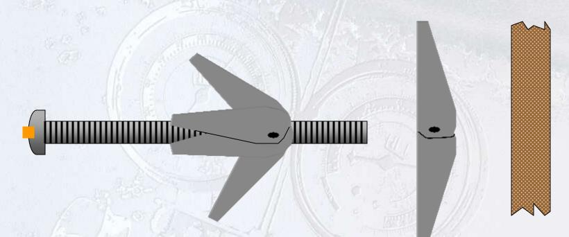
THE FOLDED TOGGLE IS INSERTED INTO THE WALL
